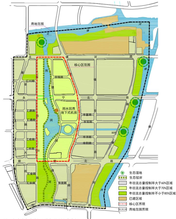
图3 海绵城市建设规划指标控制方案案例
